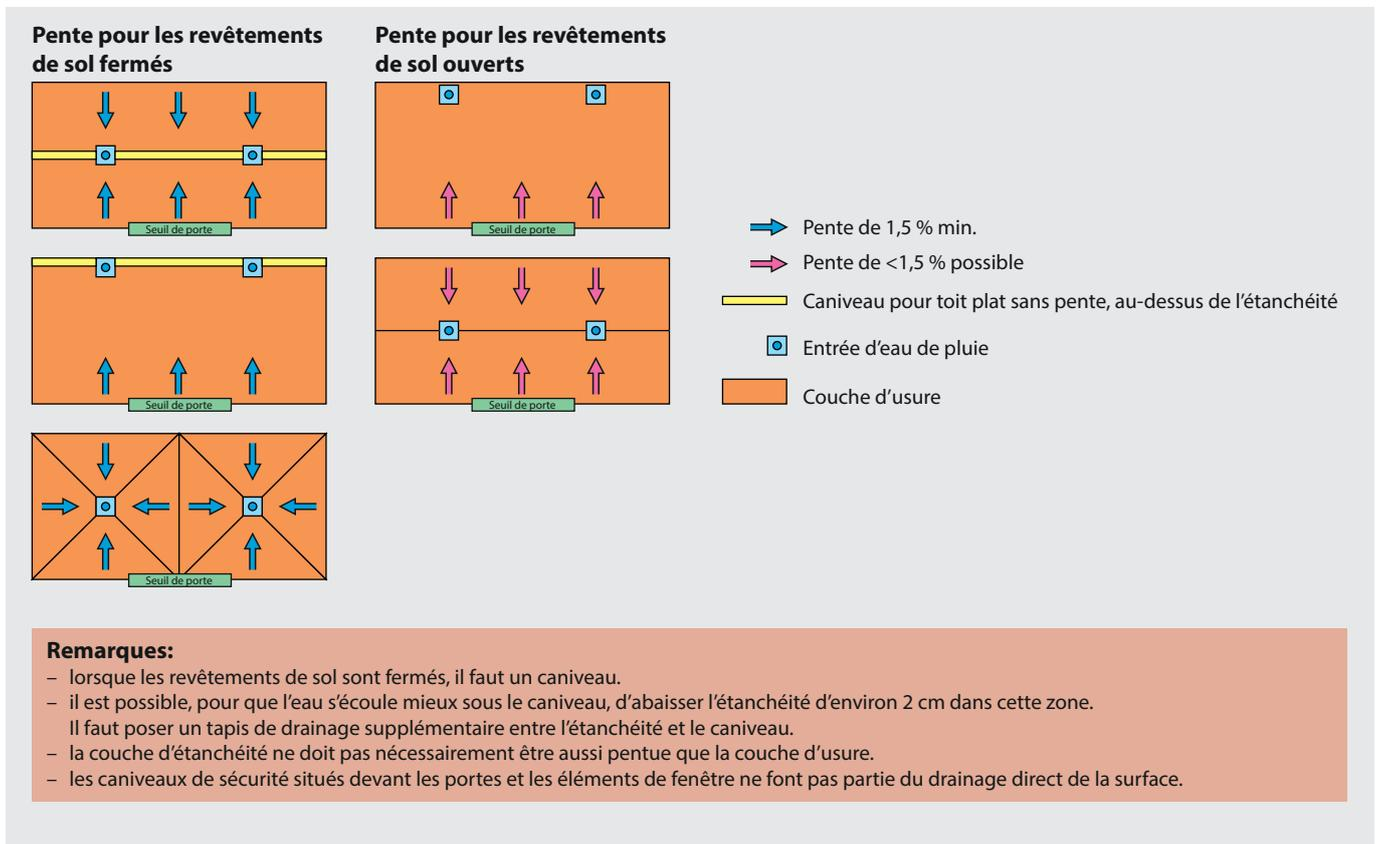
Fig. 29: exemples de pentes pour la couche d'usure.
