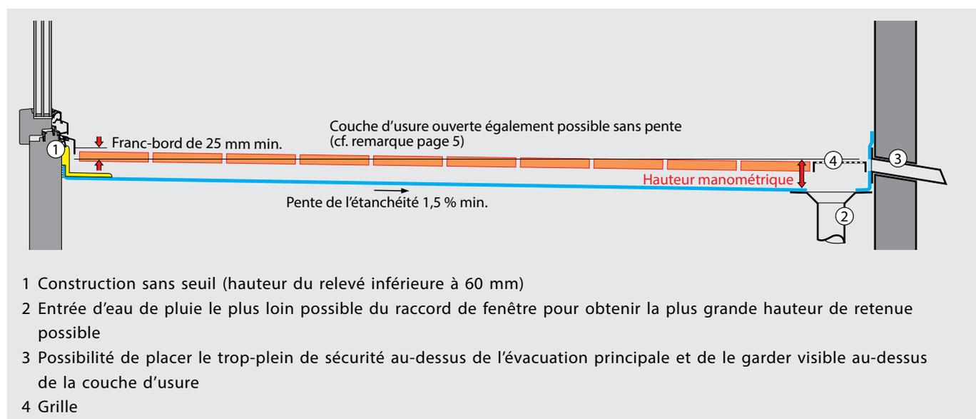
Fig. 30: exemple pour une couche d'usure ouverte.
