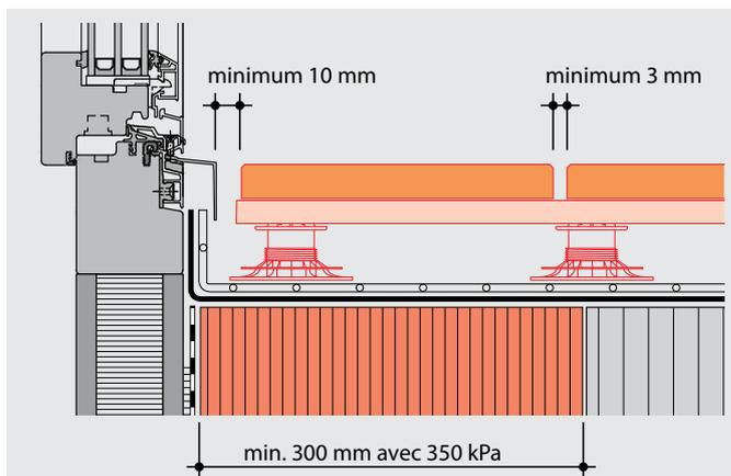
Fig. 38: pour les revêtements praticables ouverts, il n'est pas nécessaire de prévoir des caniveaux de sécurité si les conditions normatives applicables aux bords sont respectées.
