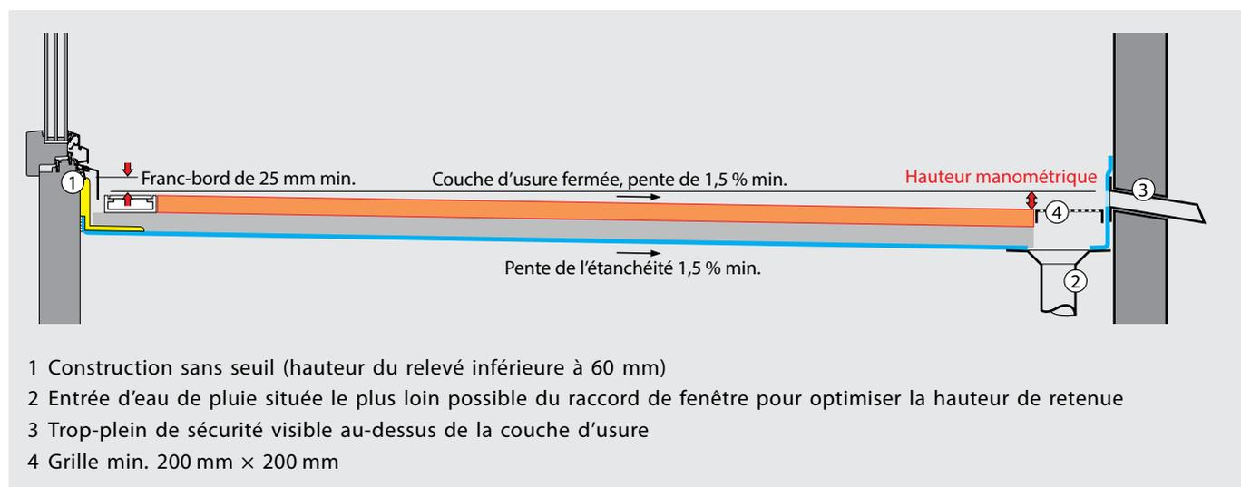
Fig. 31: exemple pour une couche d'usure fermée.
